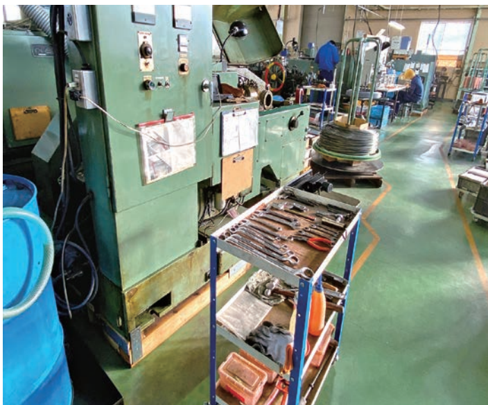
機械に木製の台座を取りつけ、低コストで稼働時間の延長を可能に
